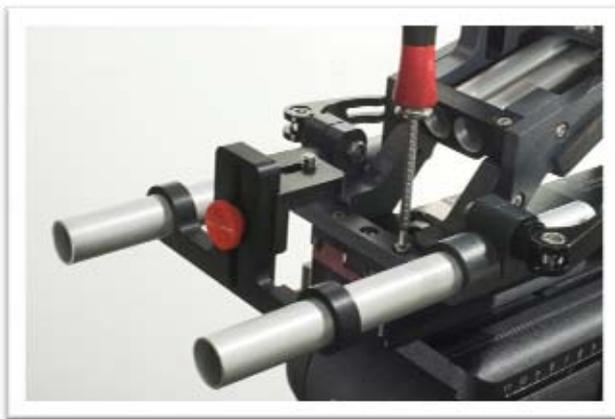
6) Anschrauben des 1D- Kameratisch Supports an die verlängerte Kameraplatte
